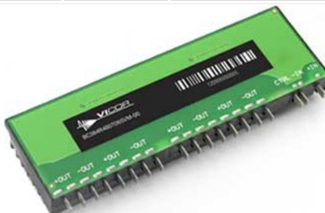
VI BRICK BCM Array
