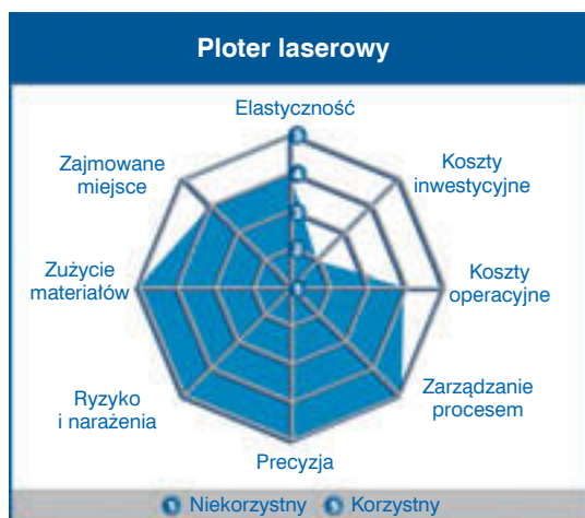
Rys. 1. Każda technologia prototypowania płytek drukowanych ma swoje mocne i słabe strony
